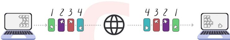
*El modelo TCP/IP divide los datos en partes que viajan separados por la red y se vuelven a ensamblar en el destino.*
